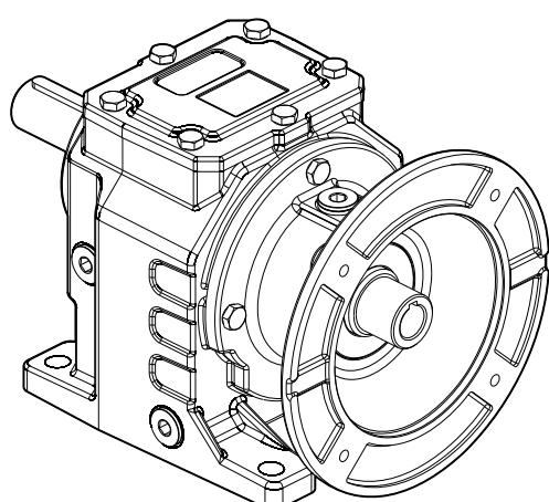
Der korrekte Einbau des Getriebes in die entsprechende Vorrichtung der Applikation ist Voraussetzung, um einen einwandfreien und dauerhaften Betrieb zu gewährleisten. Vor allem die Oberflächen der Zentrierungen/Aufnahme sind in einer Toleranz H8 zu fertigen, damit die einwandfreie Uebereinstimmung mit der Getriebeachse garantiert wird. Für die Montage des Getriebes sind nachstehende Anweisungen zu beachten:
